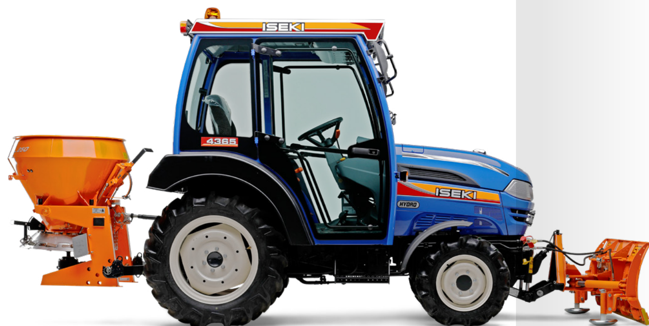
TH 4 z pługiem do odśnieżania RSS 140 i rozsiewaczem wirnikowym SA 250.
