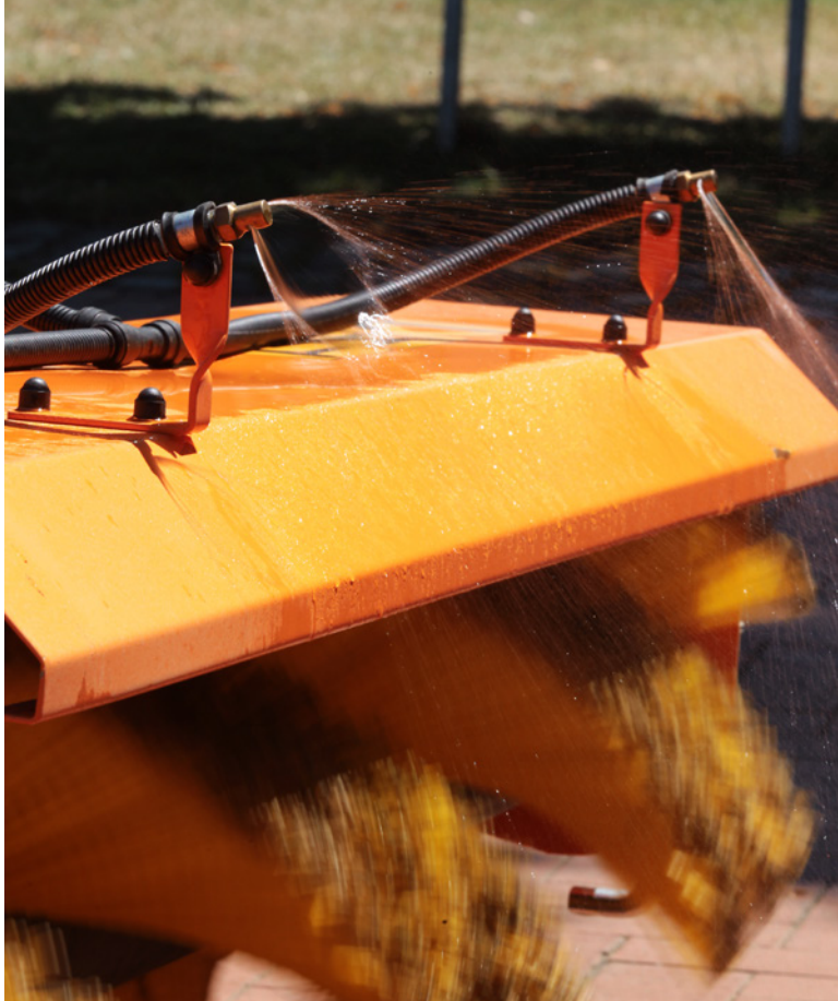
Spryskiwanie podłoża pozwala w znacznym stopniu ograniczyć powstawanie kurzu podczas zamywania.
