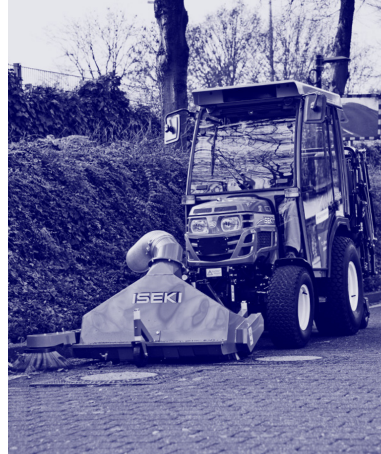
Precyzyjne i dokładne zamykanie z użyciem szczotek bocznych do czyszczenia przy krawężnikach.
